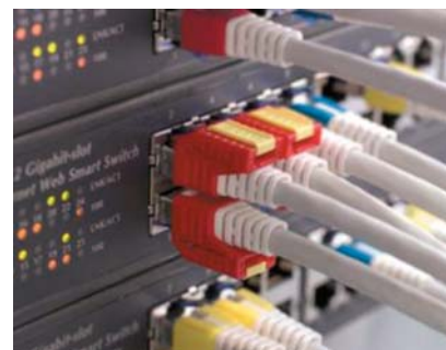
Рис. 2. Клипсы Patch Guard исключают возможность внесения несанкционированных изменений в схему коммутации
